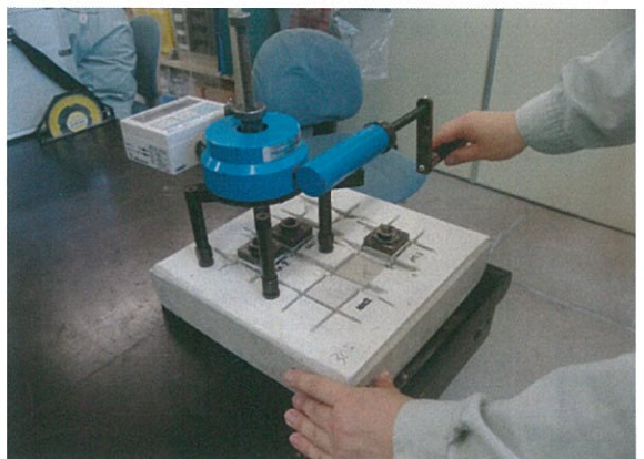
写真-4 接着強さ試験状況
