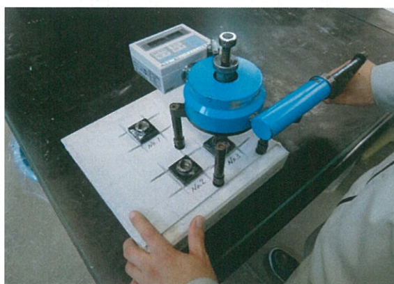
写真-4 接着強さ試験状況
